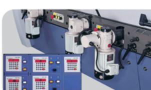
**Сервопривод позиционирования шпинделя с управлением от цифрового программируемого контроллера (опция)** Сервопривод устанавливается на любой шпиндель станка, за исключением универсального. С его помощью шпиндель позиционируется быстро и точно, снижается количество пробных прогонов заготовок при настройке.
