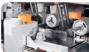
**Боковой роликовый пневматический прижимной блок напротив правого вертикального шпинделя** Боковой роликовый прижимной блок с пневматической регулировкой и дополнительные верхние прижимные ролики исключают проблему перекоса при обработке коротких, широких и кривых заготовок.
