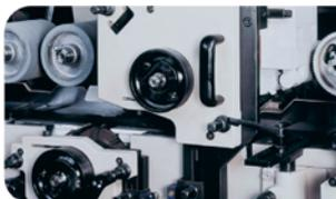
**Контропора для горизонтальных шпинделей с гидравлическим самоцентрирующимся зажимом** Специально разработанная контропора с уникальной системой гидравлического самоцентрирующегося зажима исключает вибрацию на горизонтальных шпинделях, обеспечивает максимальную стабильность обработки материала при высокоскоростных режимах работы.
