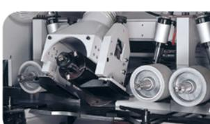
**Универсальный шпиндель (опция)** Данный шпиндель может занимать горизонтальное, вертикальное, нижнее и верхнее положение, и положение под любым углом по отношению к заготовке, обеспечивая выполнение самых сложных строгально-калевочных и распиловочных работ.
