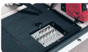
**Централизованная система смазки** Смазка всех основных узлов производится с фронтальной части станка. Данная система существенно сокращает время затрачиваемое на обслуживание станка, исключает пропуск смазываемых узлов, и увеличивает срок службы станка.
