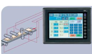
**Программируемая система ATS (опция)** Компьютерная система контроля ATS позволяет запрограммировать до 200 типоразмеров профилей заготовок. Жидкокристаллический сенсорный дисплей облегчает процедуру перенастройки и визуализирует данный процесс. Применение данной системы позволяет максимально быстро и удобно произвести перенастройку станка, и значительно снизить количество пробных прогонов заготовок при настройке.
