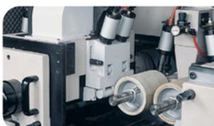
**Передняя прижимная плита с пневматической регулировкой (прижимной башмак) (опция)** Прижимная плита перед верхним горизонтальным шпинделем с плавной регулировкой усилия прижима. Плита обеспечивает максимальную стабильность прижима заготовок с минимальным расстоянием от режущего инструмента и позволяет обрабатывать заготовки с высокой скоростью подачи без потери качества обрабатываемой поверхности.
